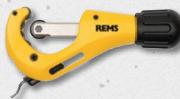
REMS RAS Cu-INOX 3-42 Řezák na trubky Ø 3-42 mm, ¼-1½", s integrovaným odhrotovačem trubek. Obj.č. 113330 R Kč 1 920,-
