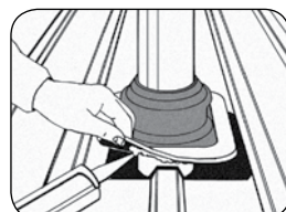
3. Nanesení těsnícího tmele.
